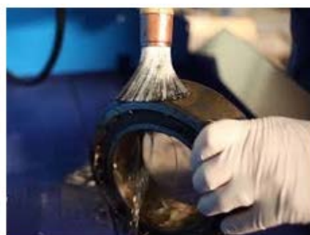
dégraissage des pièces mécaniques
