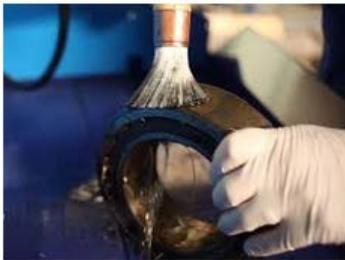
dégraissage des pièces
